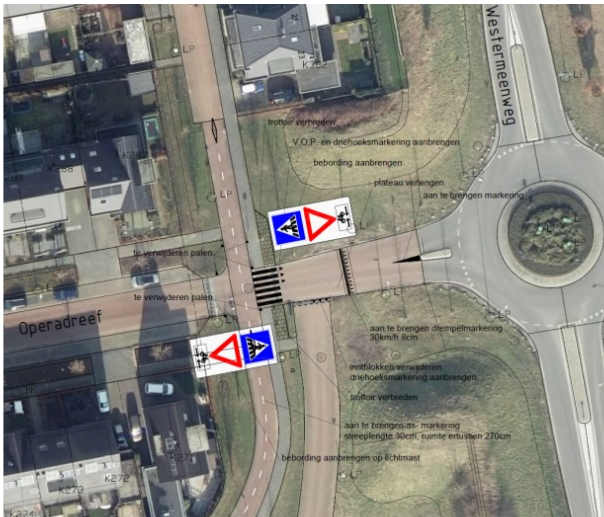
Figuur 20 – Tekening behorend bij oplossingsrichting 4. Dit betreft een aanpassing van de kruising Operadreef/Rapdreef. Het kruisingsvlak wordt groter gemaakt waardoor de kruising meer opvalt in het wegbeeld. Tekening: Gemeente Harderwijk, 2020
