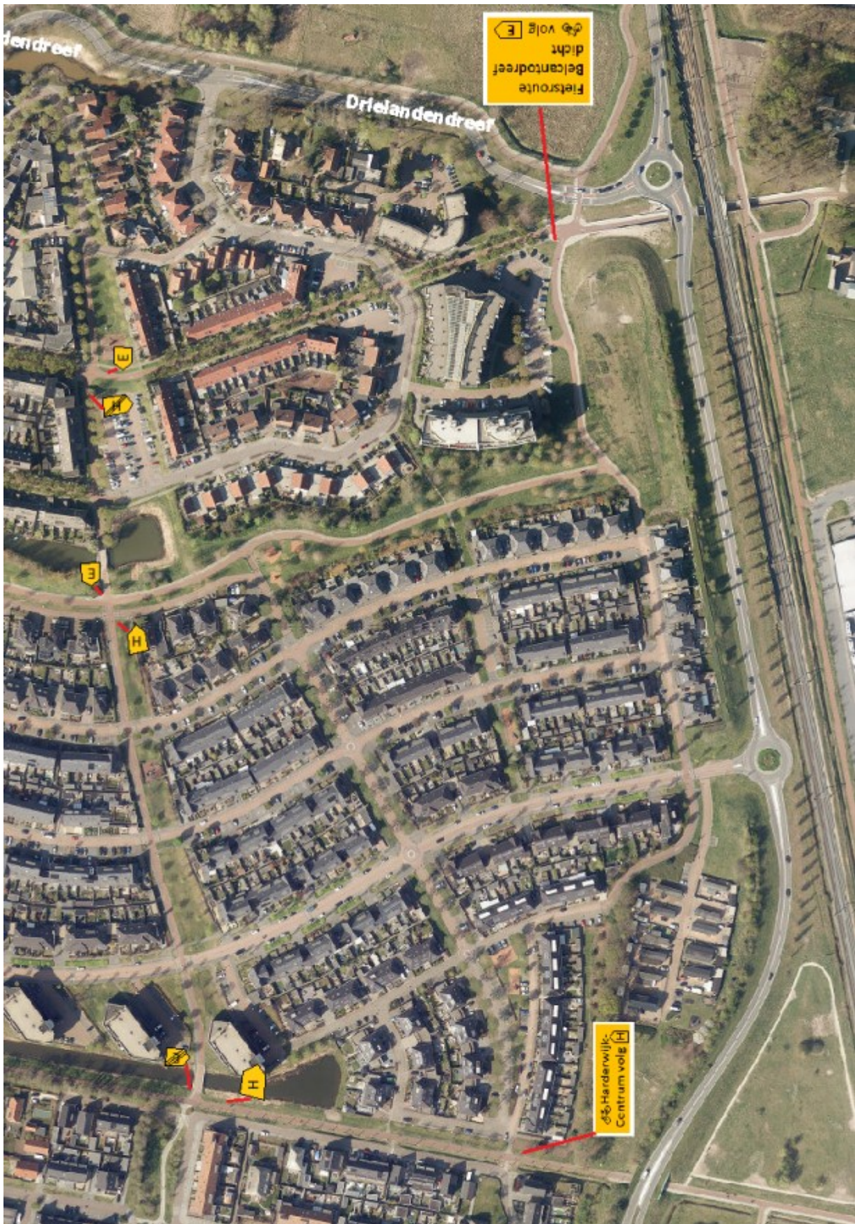
Figuur 16 – Tekening van de omleidingsbebording. Aan de hand van deze tekening is de werkelijke bebording gedurende de proefperiode geplaatst geweest. Onderaan de tekening (van links naar rechts) de Waterplassteeg. Achtergrond: GeoWeb, 2019
